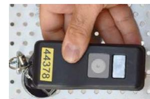
Il cavo si spezzava spesso, difficoltà nella lettura dei transponder l.f. (lettura solo se a distanza di 5 mm)
